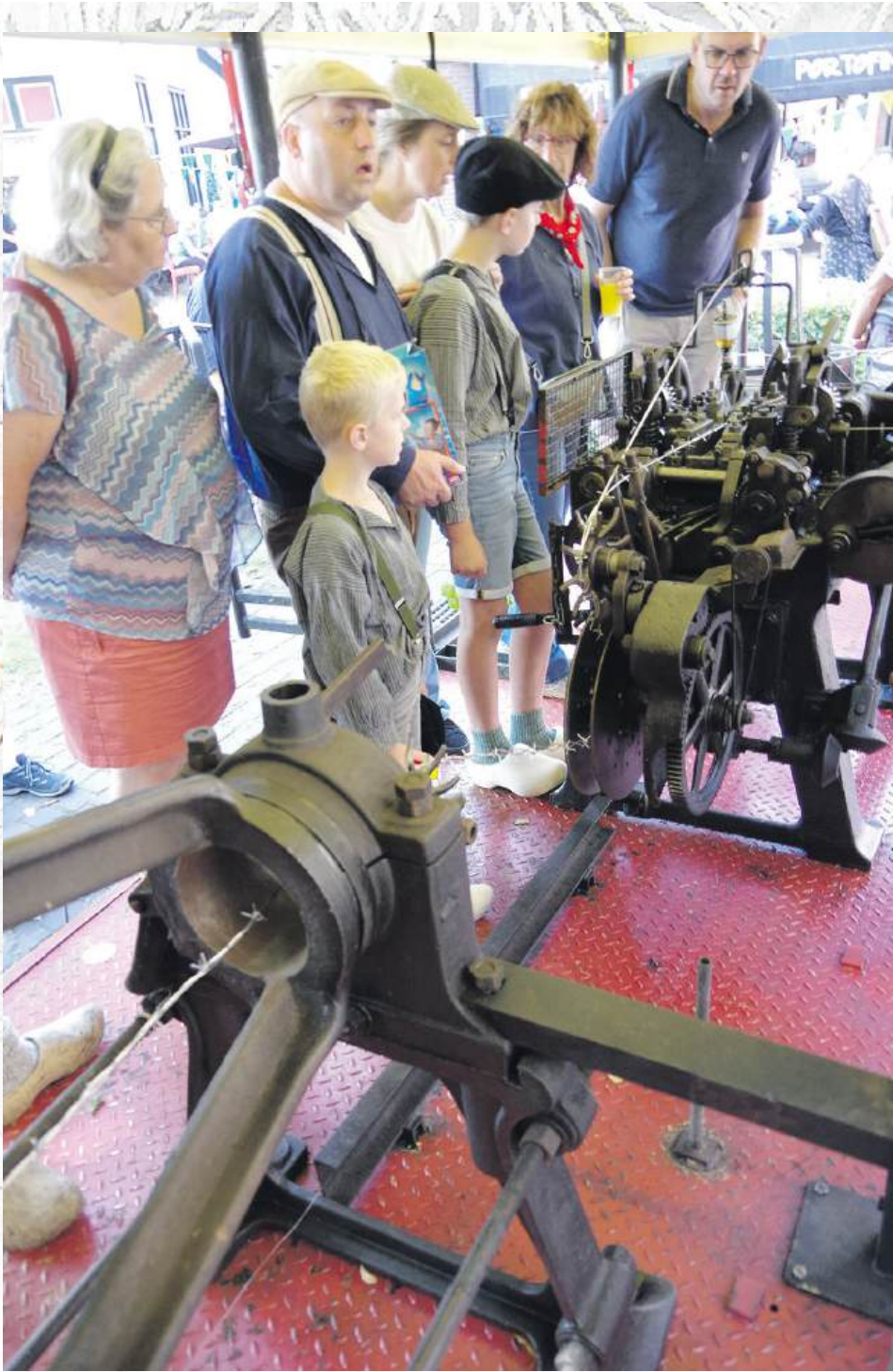
De prikkeldraadmachine op de OLD 2024. Rechterfoto: een aluminiumdraad gaat de machine in en komt er als prikkeldraad uit. Linkerfoto: het opwindmechanisme van het prikkeldraad.
