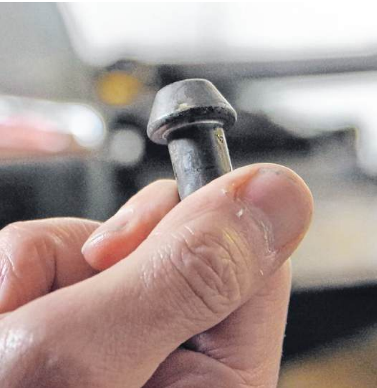
Essentieel onderdeel van een stalen roede, de enkele centimeters grotte klinknagel.
