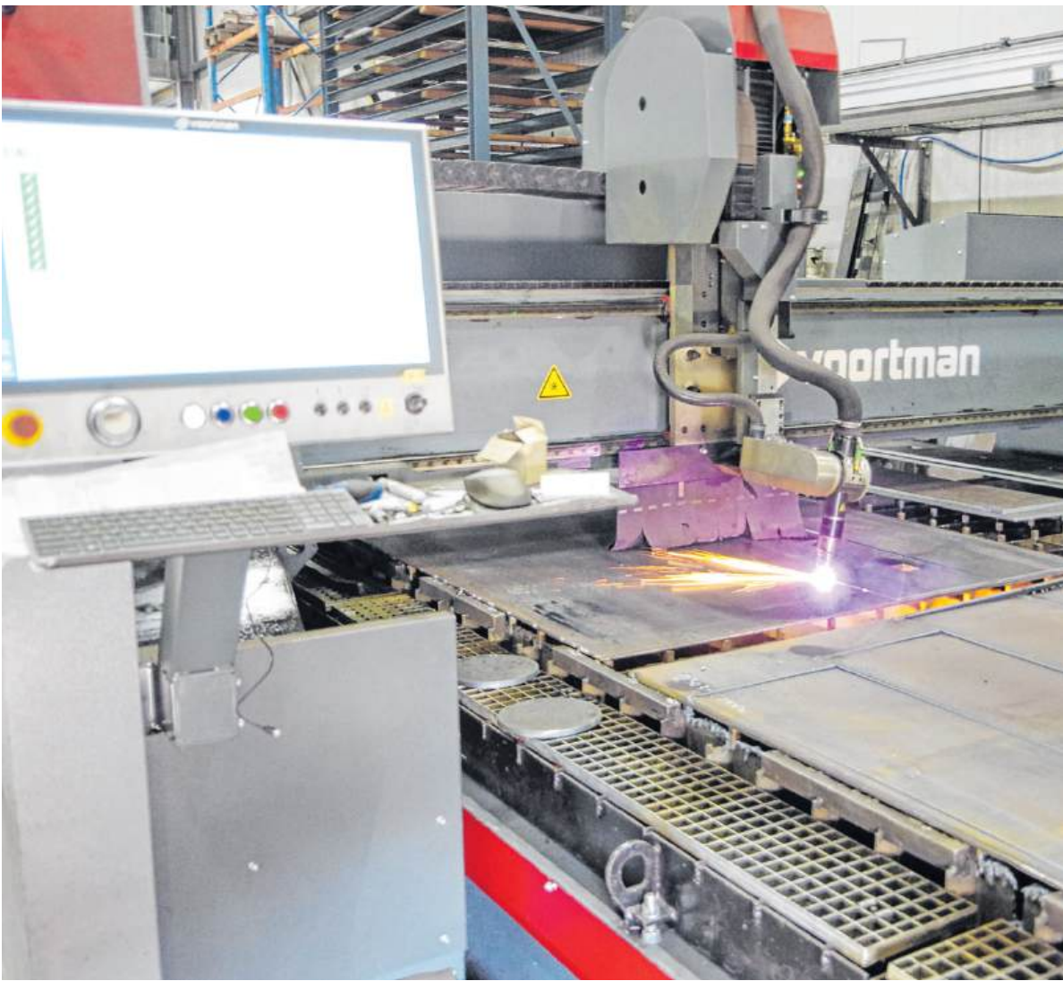
Automatisering in beeld. Het computergestuurde snijproces van stalen platen voor de roeden.
