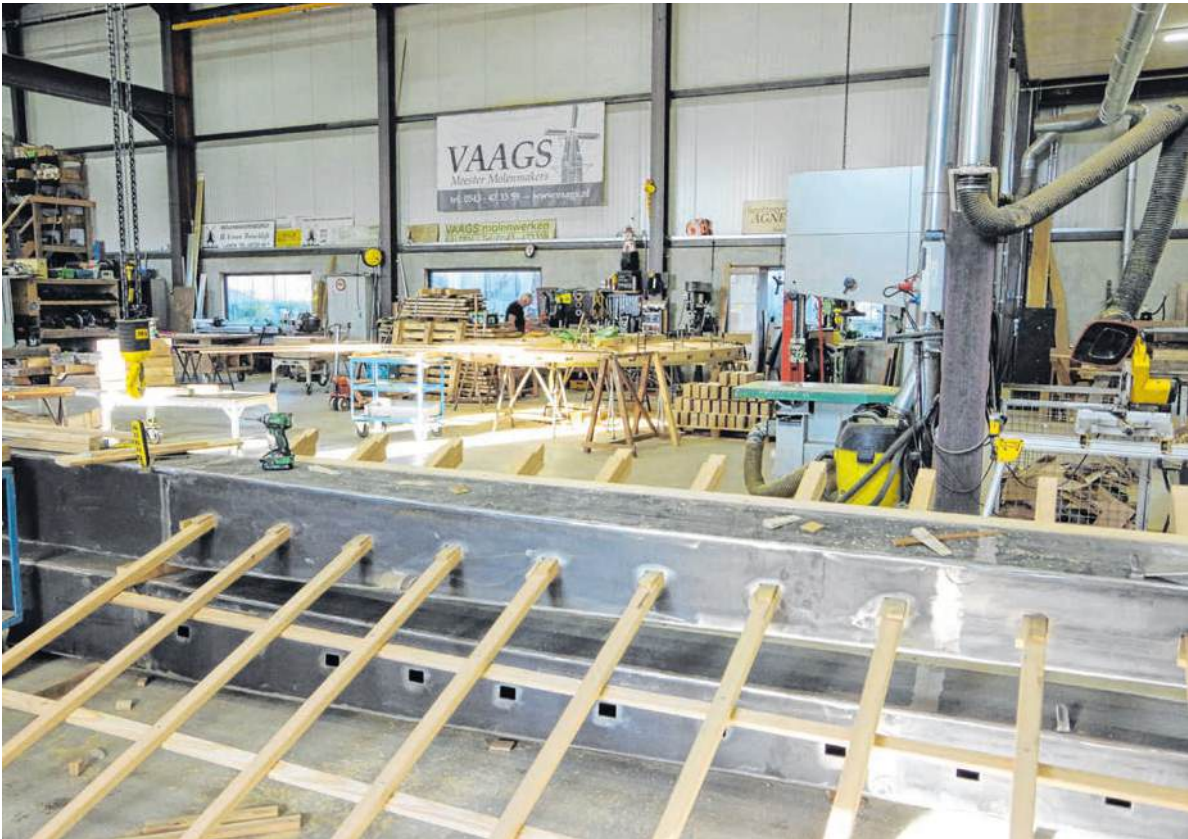
Molenmakersbedrijf Vaags: De combinatie van hout en staal onder een dak. Houten wieken in stalen roeden gestoken.
