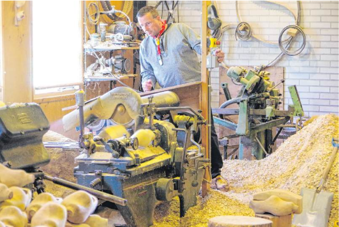
Van een blok hout wordt de schoen van de klomp gemaakt.
